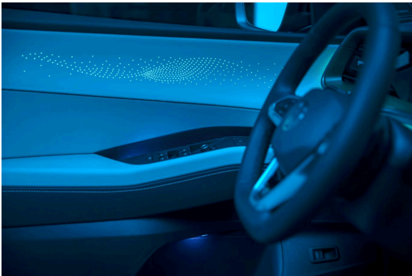
上部门板配备打孔式动态氛围灯（图源：大众）
