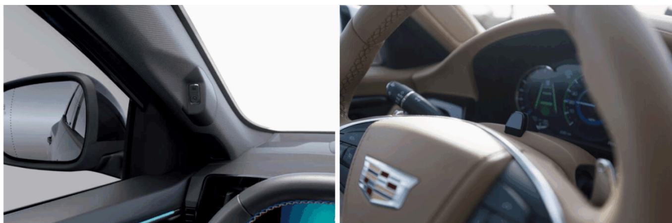
驾驶员监测系统（DMS）摄像头 —— 左侧为雷诺车型示例，右侧为凯迪拉克车型示例
