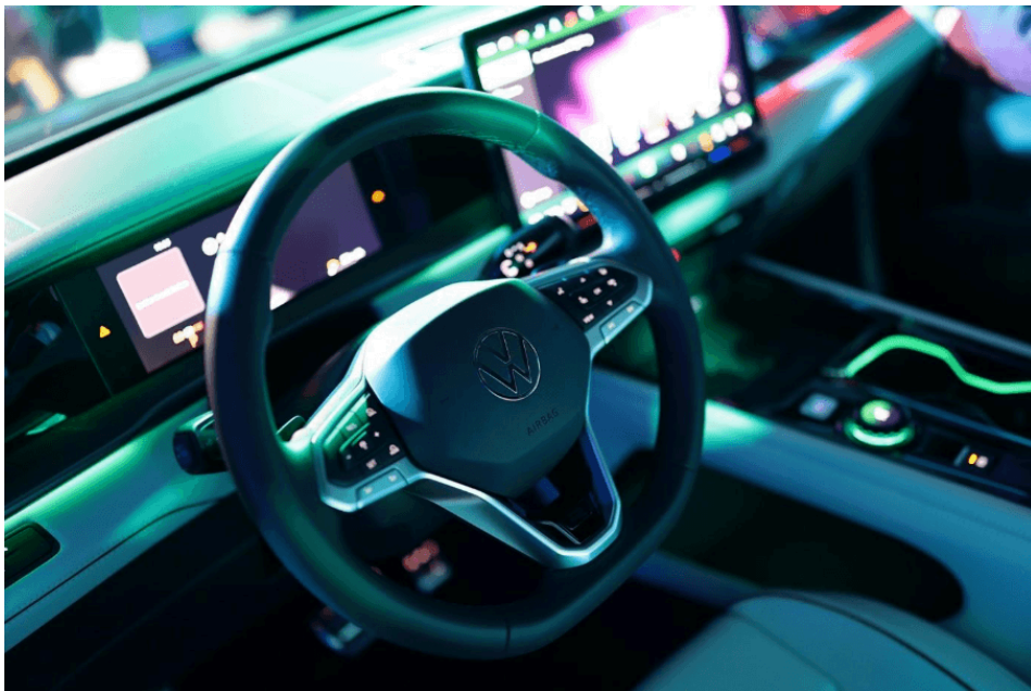
转向柱集成换挡机构的方向盘（图源：大众）
