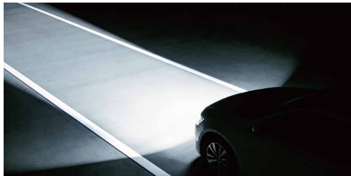
图13 照明光毯均匀性测试示意图
