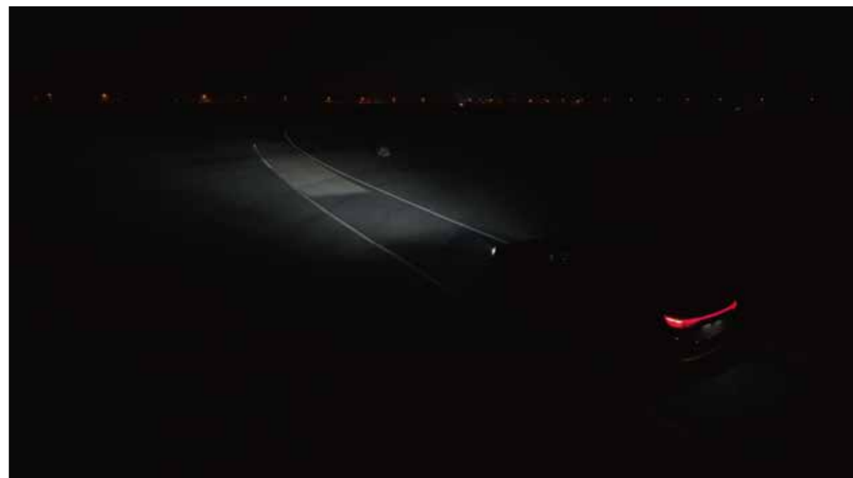
图12 照明光毯道路标线贴合实测图
