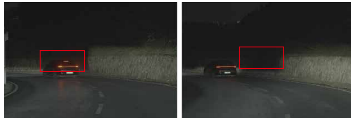
图5 高精度ADB遮蔽动态跟随实测图（左侧为正常跟随，右图为跟随失败）
