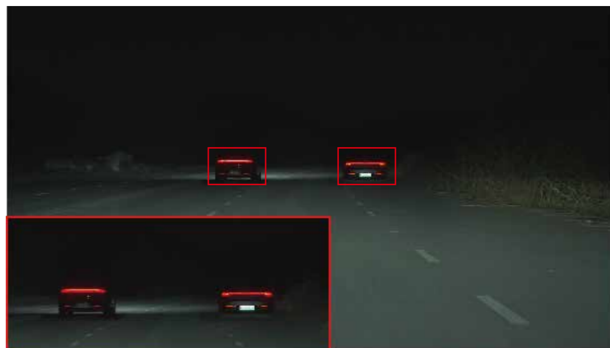
图6 高精度ADB多车目标识别实测图
