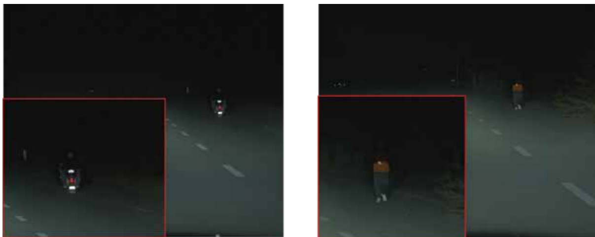
图7 高精度ADB弱势交通参与者保护实测图
