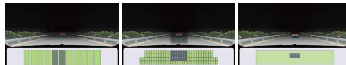
图2 不同像素ADB照明效果图（从上至下依次是简单分区ADB、低分辨率ADB、高精度ADB）
