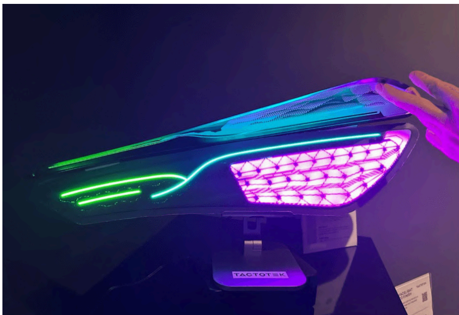
取下A面薄膜后，内部可同时看到“线型照明”与“面型照明”两种方案（图源：DVN）
