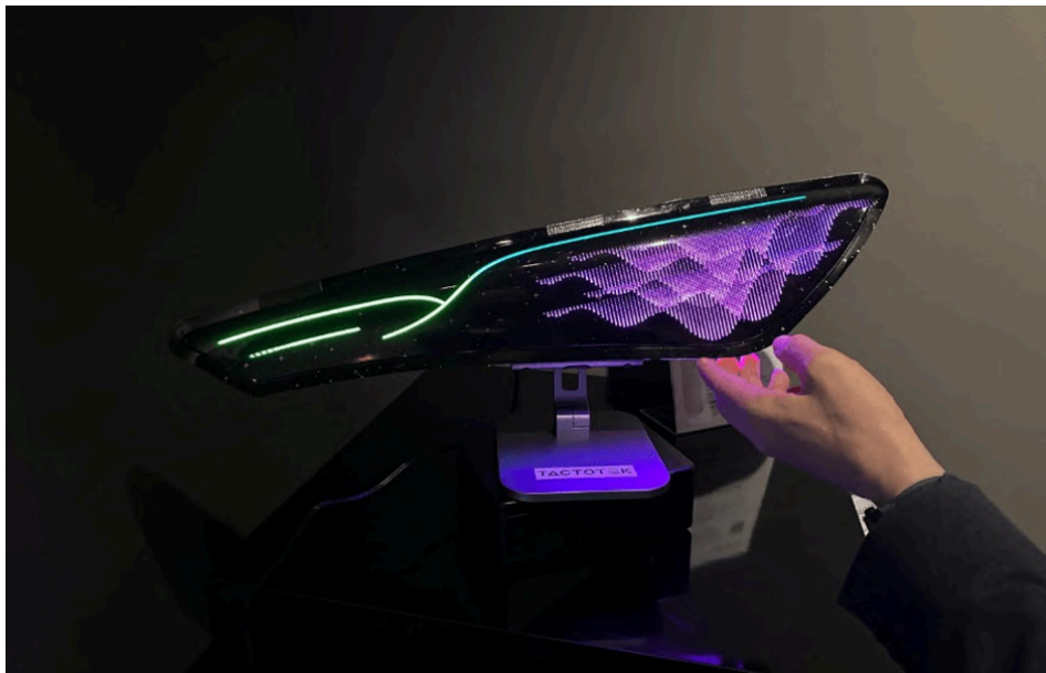
带A面薄膜的部件示例——本示例中A面薄膜为分离状态，仅作展示之用（图源：DVN）
