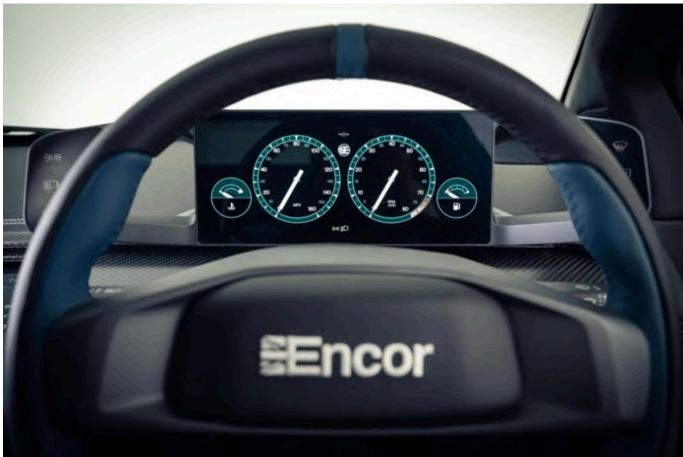
数字仪表盘界面设计简洁直观，侧边屏幕则专门用于呈现各类行车指示与详细信息（图源：ENCOR）。
