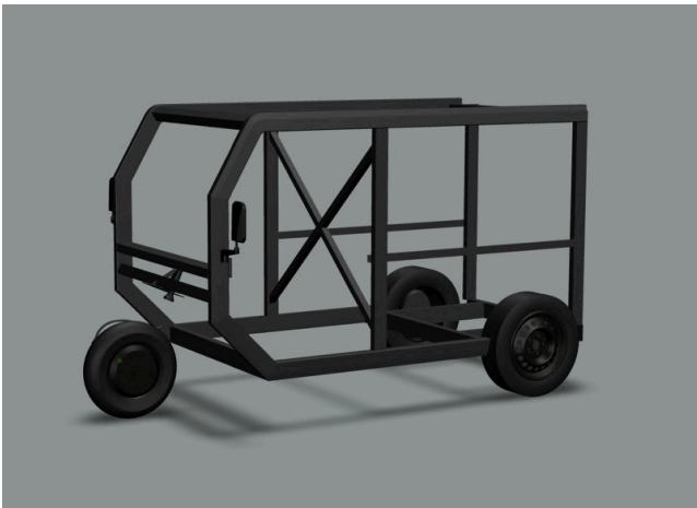
车架基础的3D CAD（图源：CLEAN MOTION）
