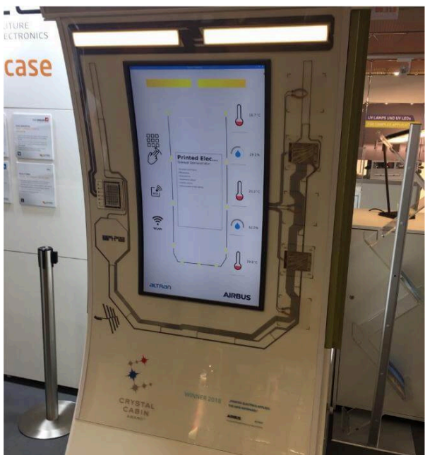
这架飞机机身的这一部分印刷了电子设备，用于：2米功率传输、WLAN天线、NFC天线、温度传感器、湿度传感器、手势传感器和OLED照明（图源：DVN）
