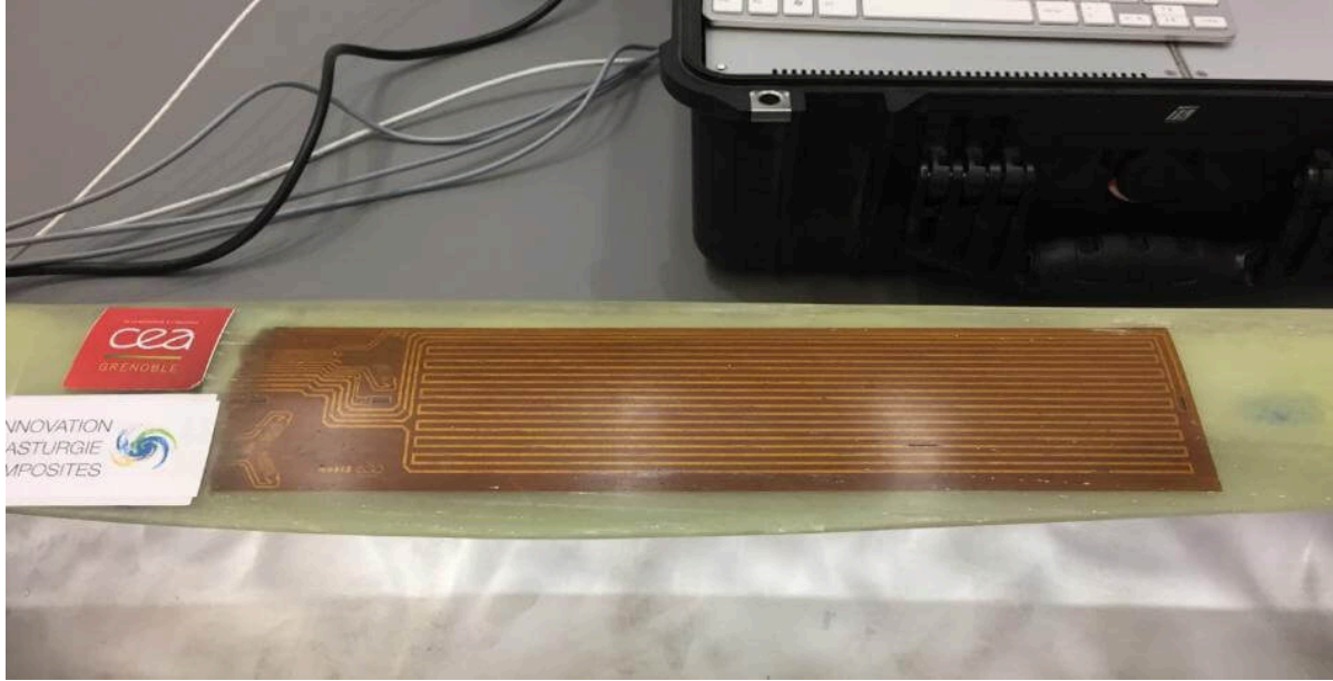
来自法国CEA的智能风车叶片——印刷应变计、加热系统和温度传感器（图源：DVN）
