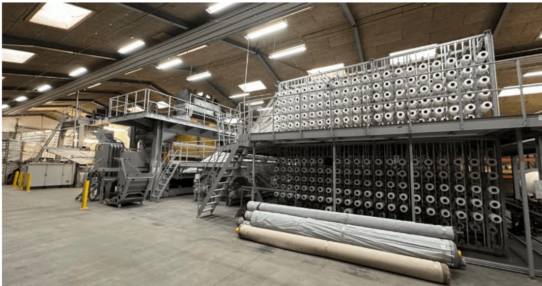
这是艺格在菲英岛勒伊勒工厂最新投入使用的织机之一。可搭载2550根独立纱线，纱线由左右两侧同步喂入——图片远端可见规格相近的纱线喂入装置（图源：DVN）
