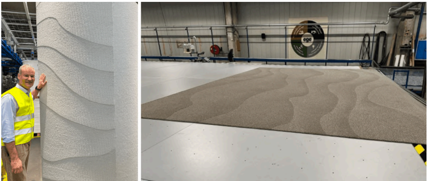
通过独立控制单根纱线张力实现3D立体效果的簇绒地毯（图源：DVN）
