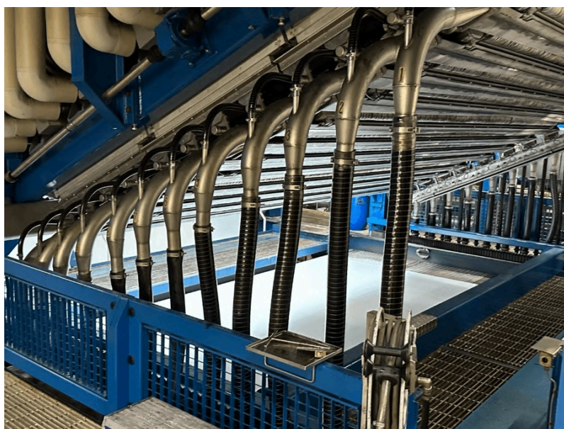
提升至检修工位的印花头区域，可见12组机架及为其输送原料的管路（图源：DVN）
