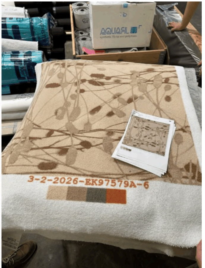
小型测试印花机生产的样品，该设备或可用于实现地毯的个性化定制（图源：DVN）
